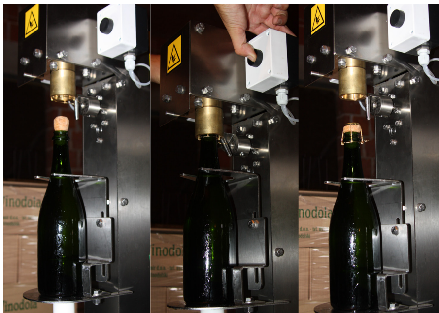
Slika 7.9. Zatvaranje boce pjenušavog vina plutenim čepom, metalnom kapicom i žičanom mrežicom (Fotografija: T. Pavlešić)
