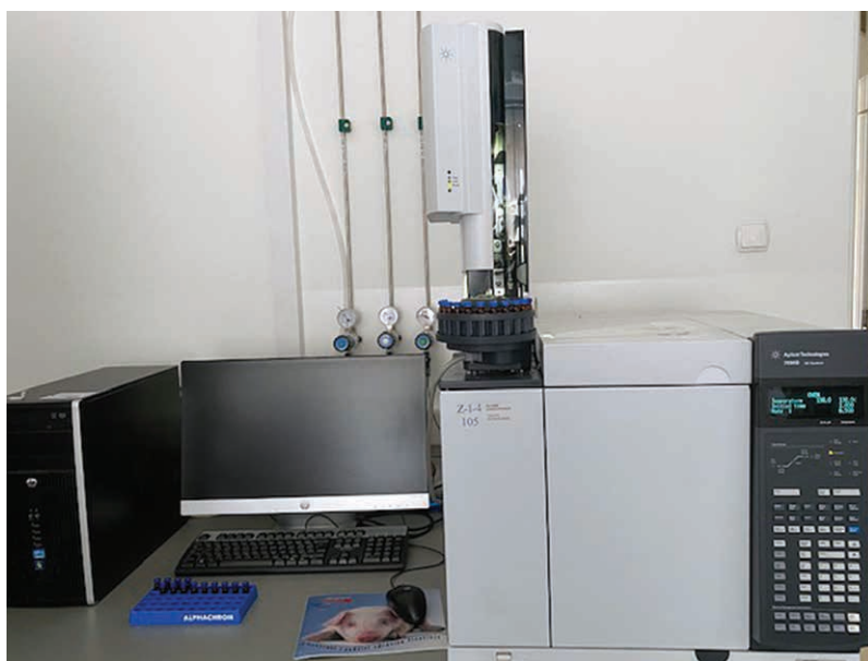
Plinski kromatograf s plameno-ionizacijskom detekcijom (GC-FID) za ispitivanje sastava masnih kiselina
