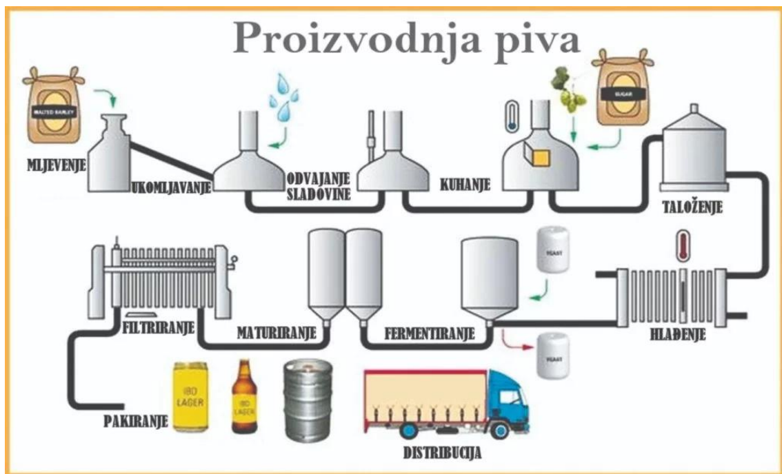
Slika 2. Proces proizvodnje piva
