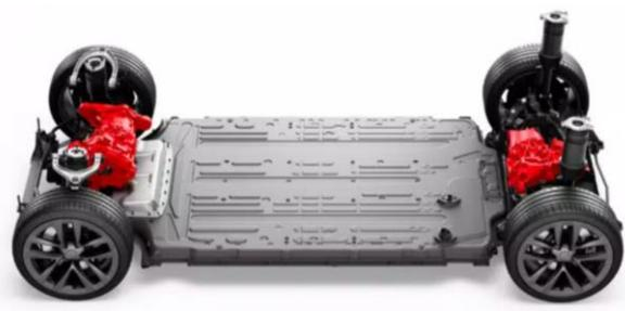
**Slika 1.** Električni pogonski sklop Modela S
