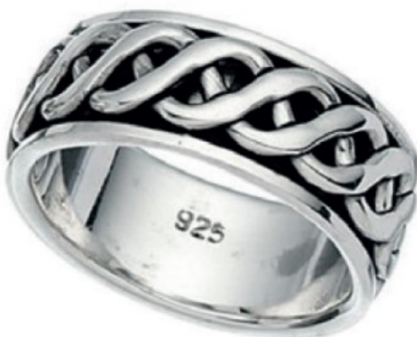
Slika 1. Primjer oznake čistoće na prstenu od srebra stupnja čistoće 925/1000
