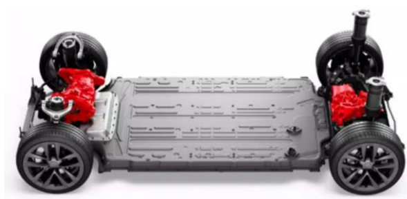
Slika 1. Električni pogonski sklop Modela S
