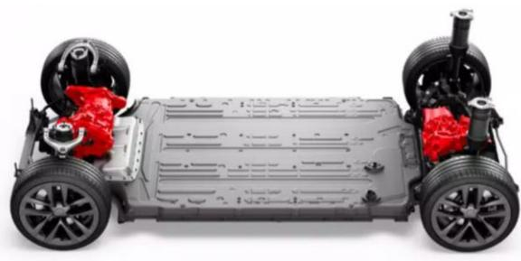
**Slika 1.** Električni pogonski sklop Modela S
